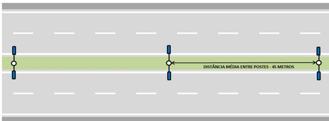
Este tipo de posicionamento, com duas luminárias instaladas em um único apoio, é normalmente usado em vias com canteiro central estreito.
