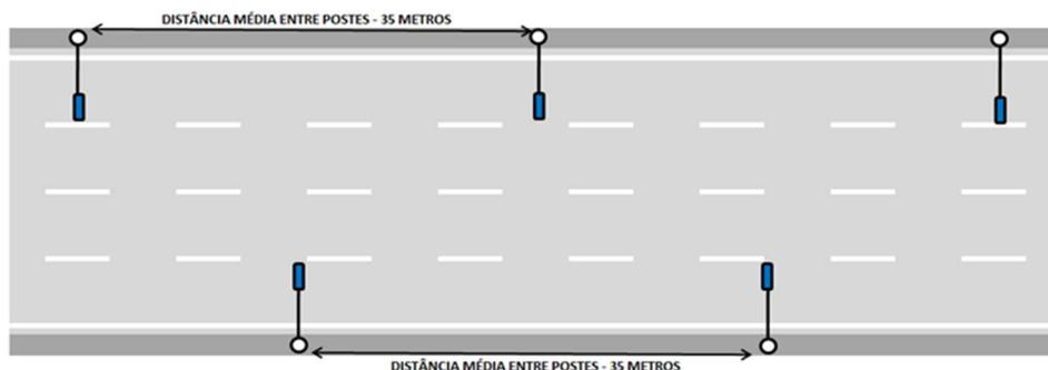
Este tipo de posicionamento, com as luminárias em ambos os lados da via em um sistema alternado, é normalmente utilizado nos locais em que as distâncias entre fachadas são de 15m a 18m ou a distância entre guias esteja compreendida entre 10m a 13m, ou excepcionalmente em ruas de grande movimento.
