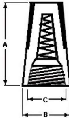
**Aplicação:** Redes INTERNAS de alimentação de energia elétrica, somando os cabos conectados e verificando em tabela o material correspondente.
